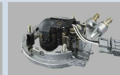
**Unitate centrală de injecție (parte superioară și inferioară):**
