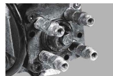
Coroziune puternică, deteriorări datorită apei sau combustibilului necorespunzător
