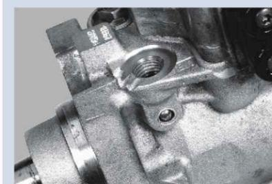
Carcasa suprafeței de etanșare sau arborele sunt deteriorate
