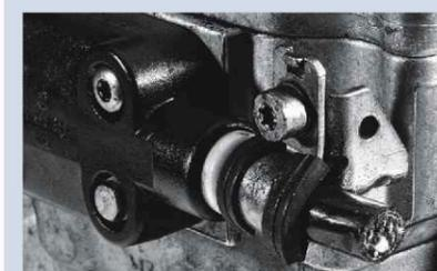
Cablu tăiat sau deteriorat - în cazul pompelor rotative cu control electronic
