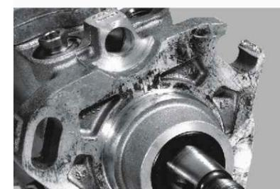
Deteriorări mecanice ale arborelui de antrenare și ale flanșei, culoarea arborelui albastră datorită încălzirii, arborele blocat, nu poate fi rotit manual
