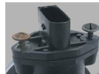
Deteriorări ale șuruburilor: deșurubate, parțial deșurubate sau alte tipuri de șuruburi
