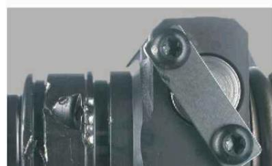
Deteriorări ale carcasei sau ale suprafețelor de etanșare
