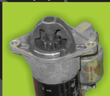
8. Semne de coroziune avansată pe pinion:
