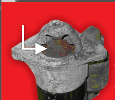
8. Semne de coroziune avansată pe pinion:
