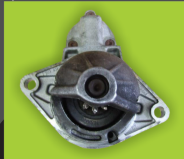
8. Semne de coroziune avansată pe pinion:
