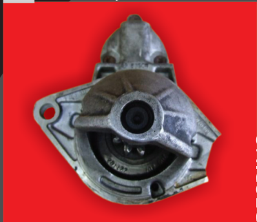
8. Semne de coroziune avansată pe pinion:
