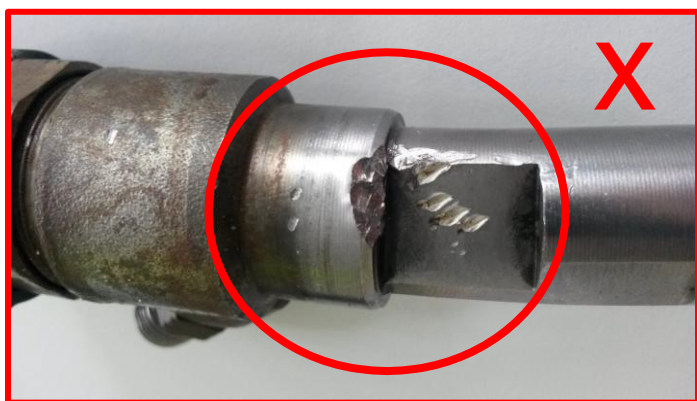
Corp deteriorat mecanic (de ex. cu ciocanul) → neacceptabil
