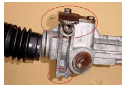
Puncte de fixare deteriorate
