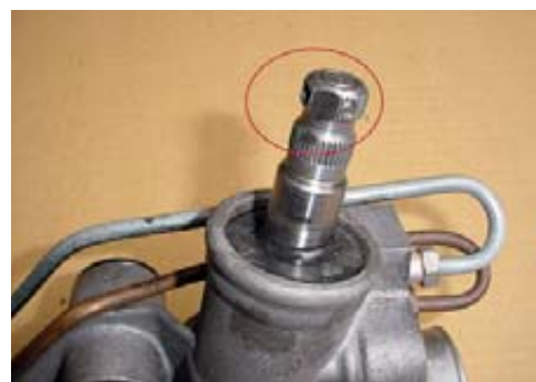
Dinții arbore deteriorați
