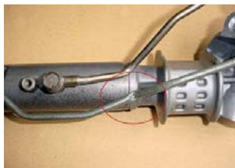
Conducte deteriorate sau lipsă
